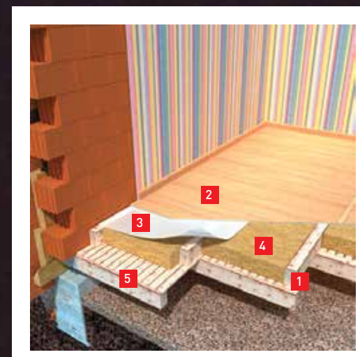
Утепление перекрытия по деревянным балкам
